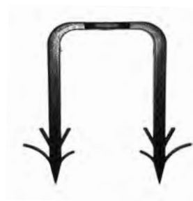
W983-2 ruční spona min. tloušťka izolace 35 mm výška sponky 55 mm, pro přichycení hadic do Ø 26
