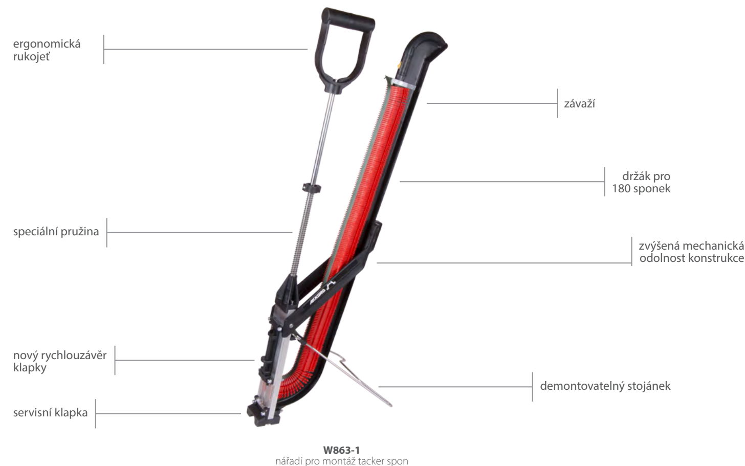
W983-1 tacker spona min. tloušťka izolace 25 mm výška sponky 40 mm
